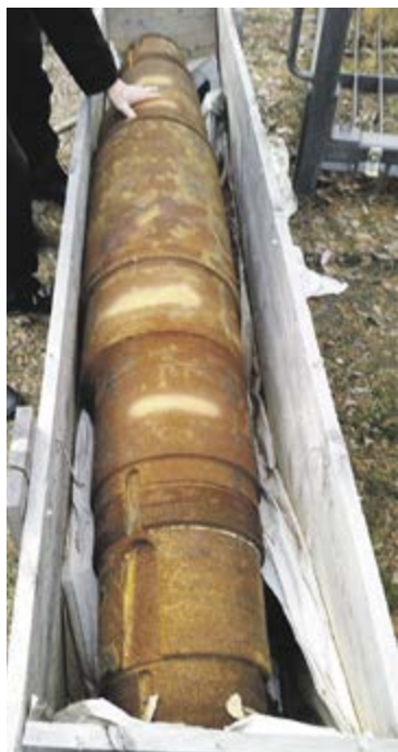
Murskaimen akseli ennen laserkäsitelyä ja sen jälkeen.
