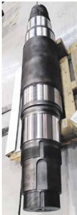
Murskaimen akseli ennen laserkäsitelyä ja sen jälkeen.
