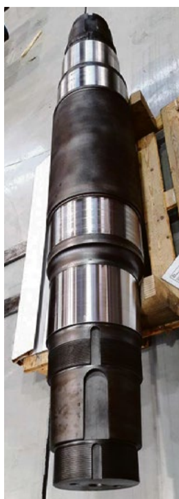
Murskaimen akseli ennen laserkäsitelyä ja sen jälkeen.
