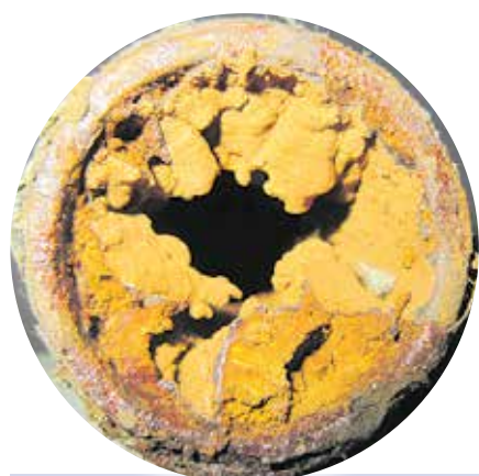
Kalkki- ja ruostekerrostumaa kylmävesiputkessa.
