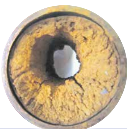
Kalkki- ja ruostekerrostumaa kylmävesiputkessa.
