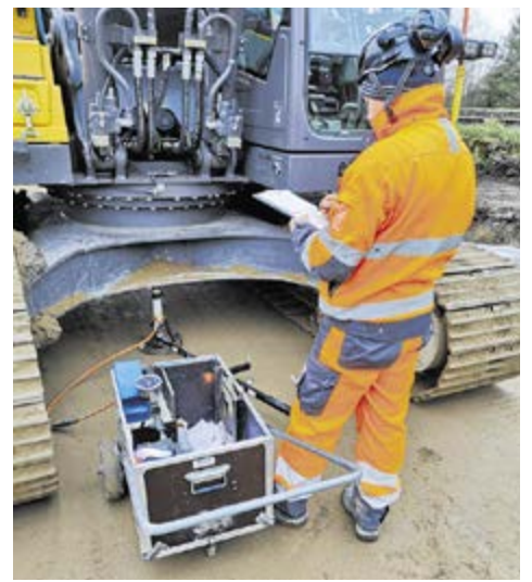
Levykuormituslaitteella lasketaan kantavuuksia.
