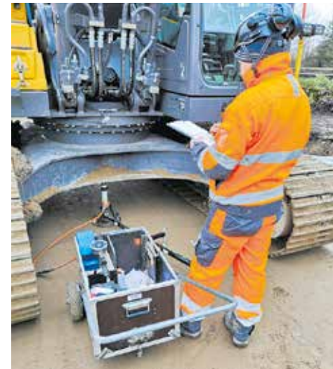
Levykuormituslaitteella lasketaan kantavuuksia.
