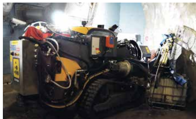
Kairaus Savilahden kalliotilassa Comadevin Geopard Georoverilla. Kuva: Eetu Pussinen.
