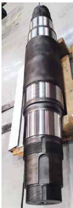
Murskaimen akseli ennen laserkäsittelyä ja sen jälkeen.
