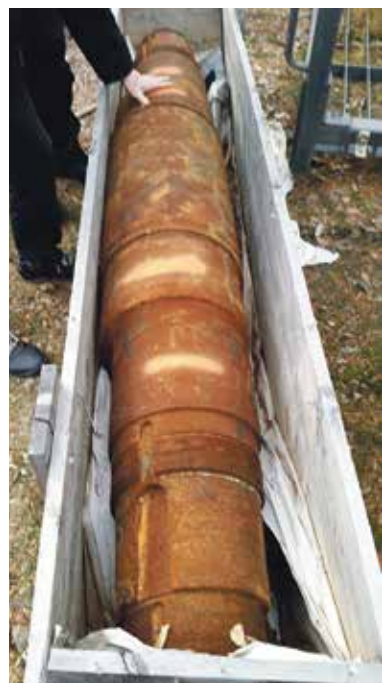
Murskaimen akseli ennen laserkäsittelyä ja sen jälkeen.
