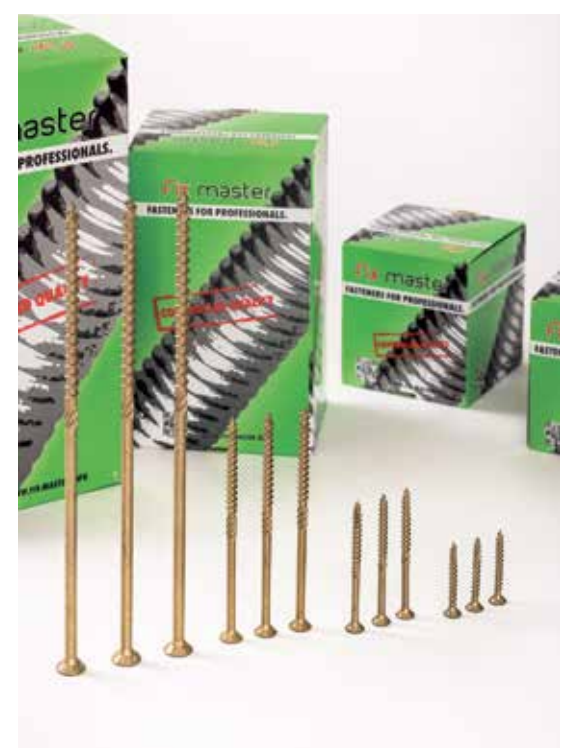
Korroosionkestävien Ultra-ruuvien SmartFix-kärki, asymmetrisen kierre ja jyrsinurat varressa tekevät asennuksesta nopeaa ja vaivatonta. Torx-vääntö ja kannan alla olevat jyrsinurat takaavat siistin lopputuloksen.
