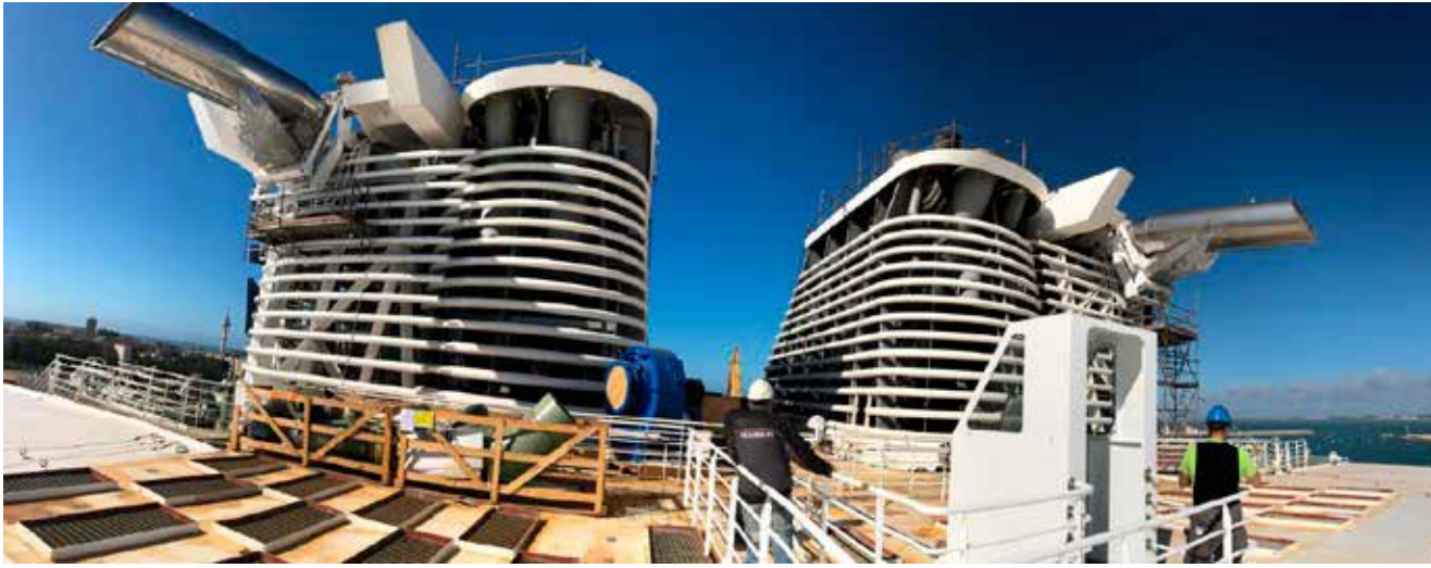
Kuvassa Oasis of the Seas -valtameriristeilijään asennetut Tailpipe-mekanismit. Kun teleskooppipiippu on laskettu, scrubberin pakoputket voidaan ajaa kelkkaa pitkin ulos piipun peräpuolelle, jotta laiva mahtuu kulkemaan sillan ali.
