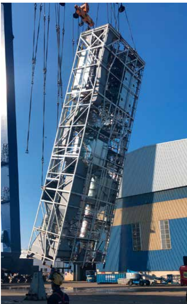
Kuvassa on alkamassa 35-metrinen ja 180 tonnia painavan konekuilumoduulin laivaan nosto.
