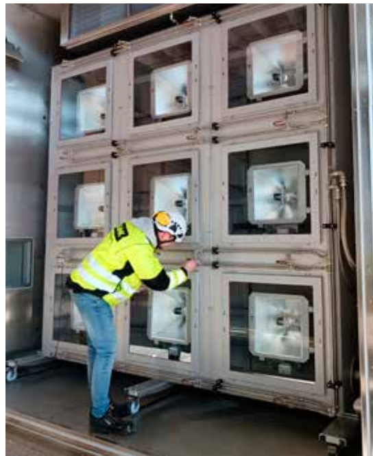
Projektityöntekijä Niko Kinnunen tutkii säätestauskammion sadetussuuttimia
