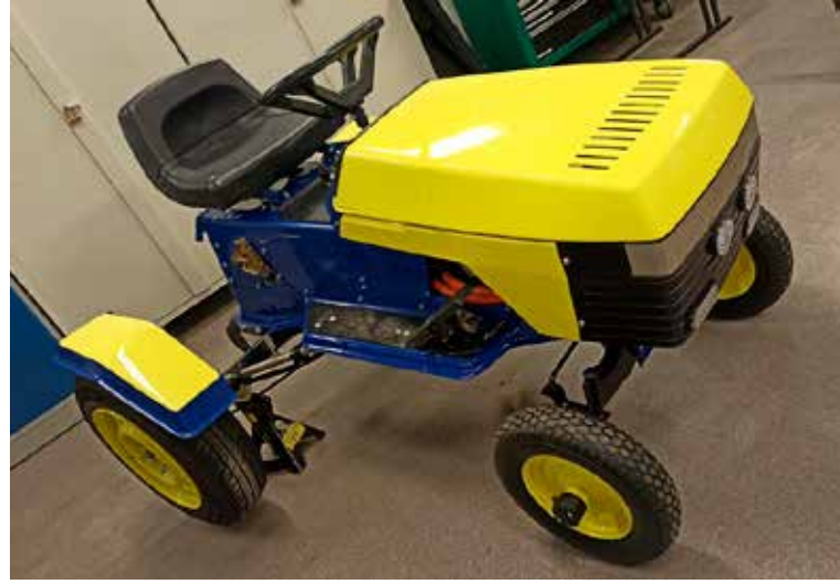
Kuvassa KATI-hankkeessa rakennettu sähköinen havainnointiväline (SLH). Alustana on käytetty käytöstä poistettua ruohonleikkuria.
