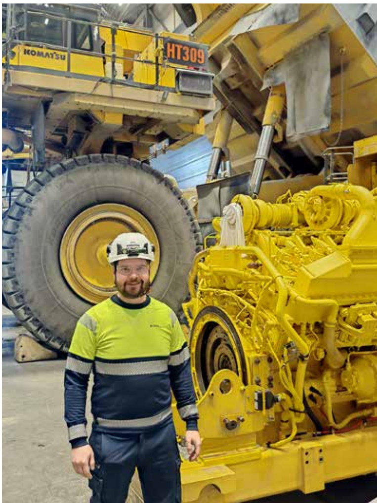
Kuvassa SR-O:n palvelupäällikkö Jusa Niskanen esittelee peruskunnostettua Komatsu 830E-5:n Cummins QSK60 moottoria jonka nettoteho on 2500 hevosvoimaa.
