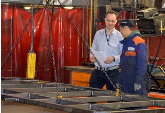
Peräkärryn päällirakenne tekeillä asiakkaalle. Metallialalla opiskelu on paljolti asiakastyölähtöistä varsinkin jatkuvan oppimisen opiskelijoilla.
