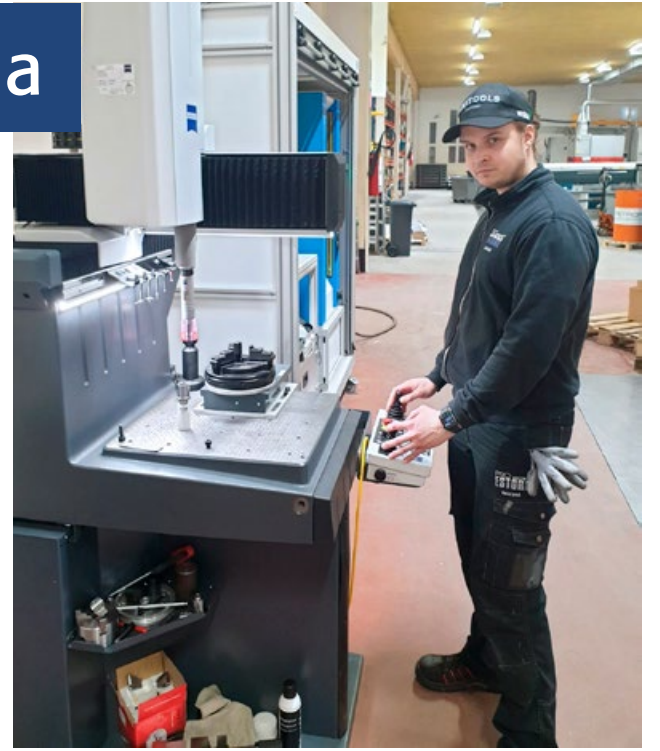
Eemil Vinkki tarkastaa juuri valmistunutta kappaletta Zeiss DuraMax -mittalaitteella.
