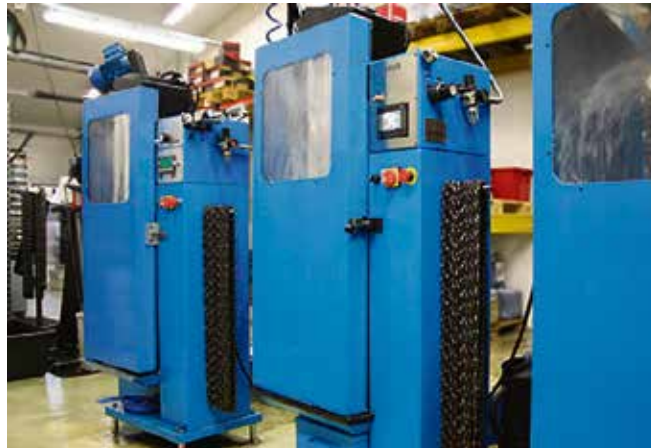
Nykyaikainen nestejäähdytteinen teroituskalustomme takaa paremman ja kestävämmän ketjujen teroituksen.
