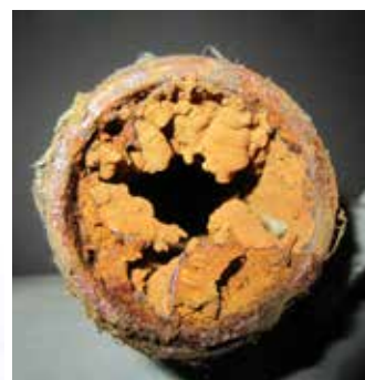
Kalkkia ja ruostetta käyttövesiputkessa.
