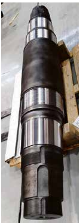
Murskaimen akseli ennen laserkäsitelyä ja sen jälkeen.
