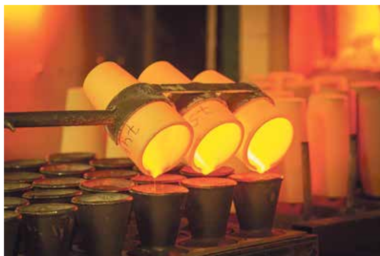
Fire Assay -menetelmää pidetään luotettavimpana kullan, platinan ja palladiumin määrittämiseen.
