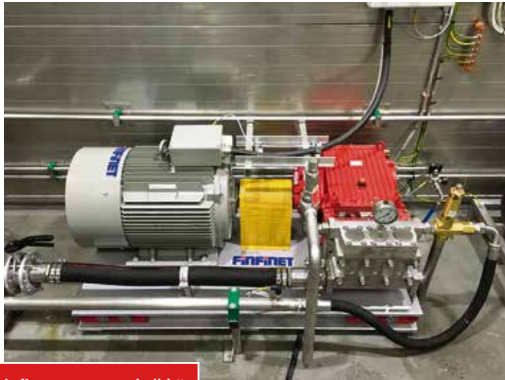
Finfinet pumppuyksikkö 75kw 350L/min 100bar.
