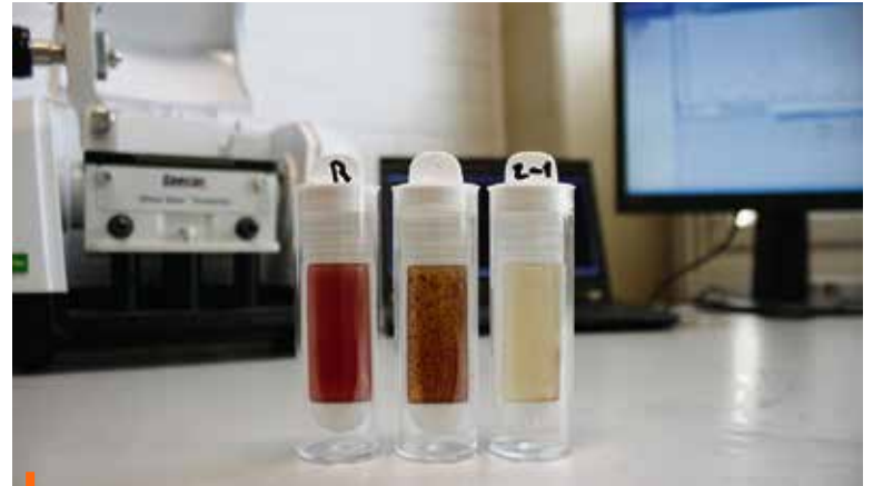
Työstönesteen bakteerien vähentyminen arvosta 100 miljoonaa PMY/ ml nolleen yhdellä monivaiheisella puhdistuskerralla.
